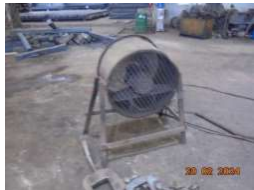
รูปที่ 61 ระบบระบายอากาศเฉพาะที่ขณะเปลี่ยนอิฐทนไฟ
